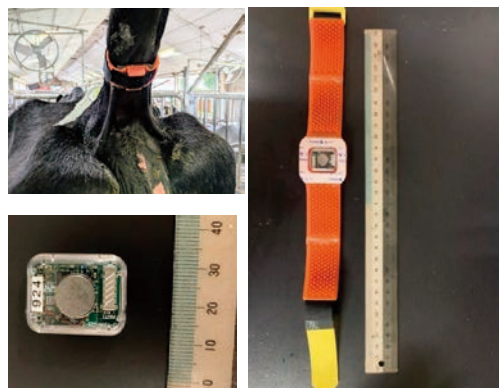
多機能尾部センサ 20.1×26.0×9.7mm ゴム製ベルトに収納して尾部腹側に装着 体表温度と加速度を3分間隔で測定
